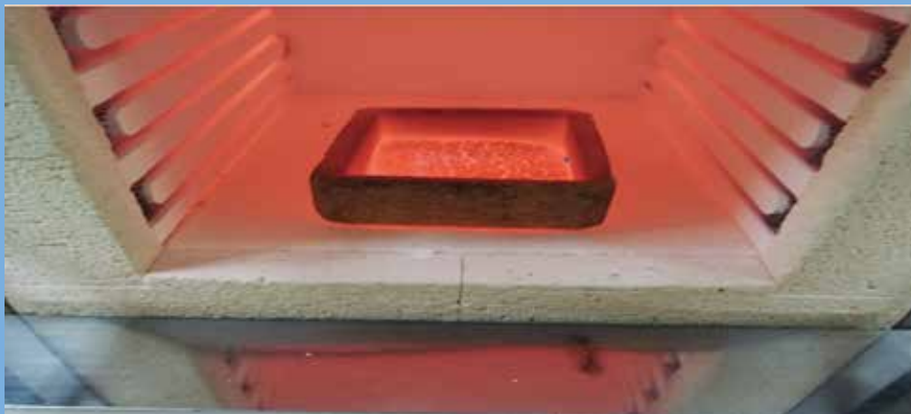
شکل ۱ سوختاندن نمونه زغال سنگ در داش (۷).
