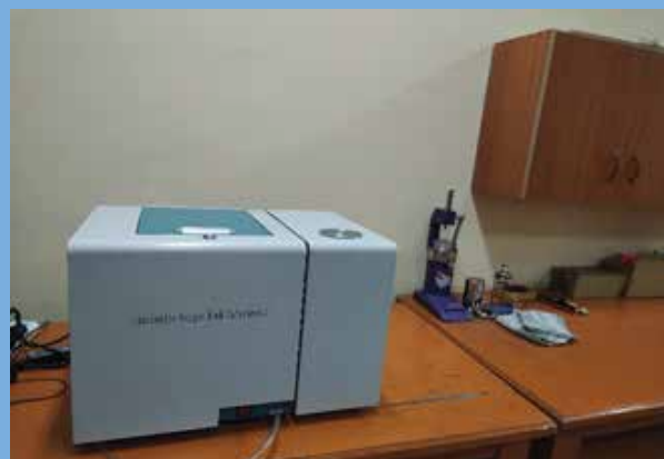
شکل (۴): دستگاه اکسیجن بمب کالوری متر لابراتوار کیمیای زغال سنگ وزارت معادن و پترولیم (۷).
