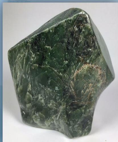
نفرایت یک نوع متراکم و فایبری جید (یشم) می‌باشد که عمدتاً متشکل از امفیبول های تریمولیت  $[Ca_2Mg_5(Si_8O_{22})(OH)_2]$  تا اکتینولیت  $[Ca_2Mg_5(Si_8O_{22})_2(OH)_2]$  بوده و در ترکیب آن به صورت جزئی دیوپسید، گرانات (گراسیولار)، مگنیتیت، کرومیت، گرافیت، اپایت، روتیل، پیریت، تالک، پولی مورف‌های سرپتینین و تیتانیت شامل اند. نفرایت در رنگ‌های مایل به سفید تا سبز تاریک به مشاهده می‌رسد. درجه سختی نفرایت نظر به مقیاس ماووس (۶.۵ - ۷.۰) و وزن مخصوص آن (۲.۹ - ۳.۱) می‌باشد.
